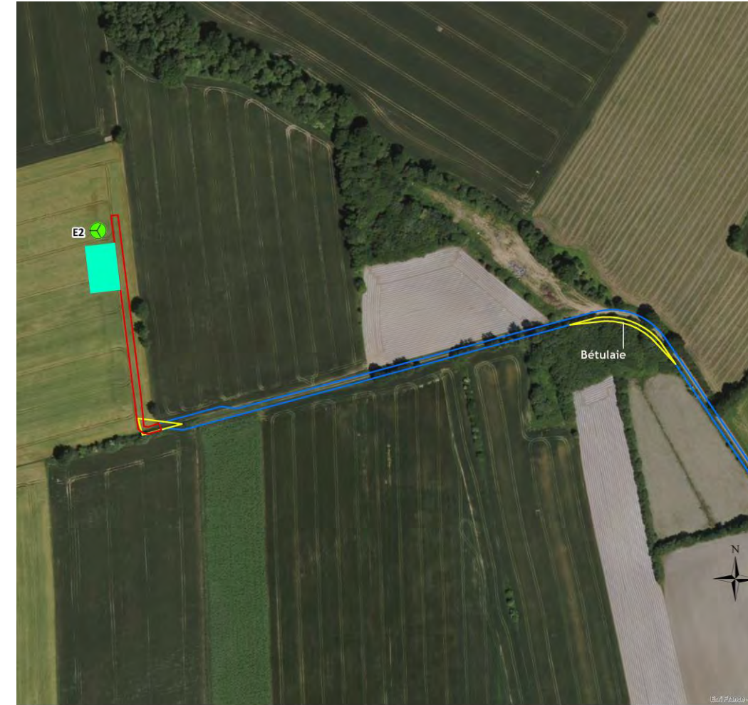
Illustration 48 : détail de l'implantation modificative de l'éolienne E2 et de la rectification du virage de sa voie d'accès nécessitant un arasement de 220 m 2 de saulaie
